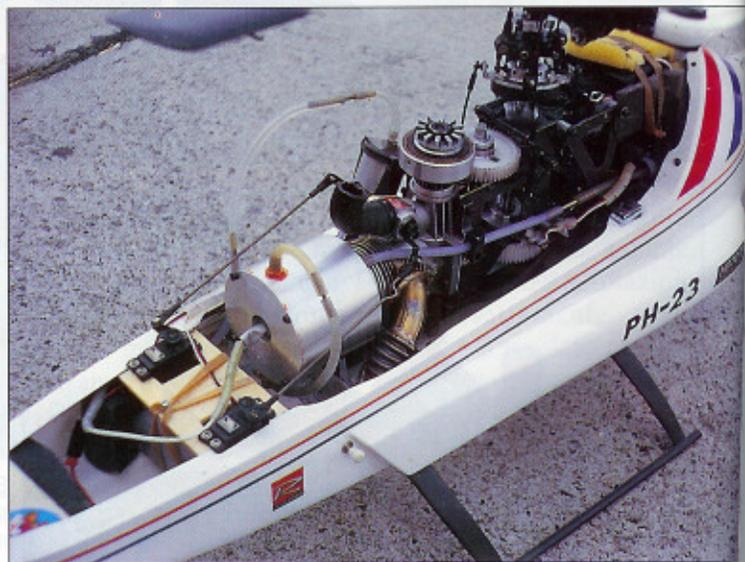
Il modello autocostruito Mystere dell'olandese Cees Verplanken: alla testa del suo motore è stato aggiunto questo grosso cilindro che contiene 150 cc. di acqua che, una volta in ebollizione, si travasa all'interno dello scarico e viene espulsa. L'acqua è sufficiente per un volo di oltre 10 minuti. Con questo sistema si è eliminata la ventola di raffreddamento ed il motore funziona regolare che è una bellezza.
